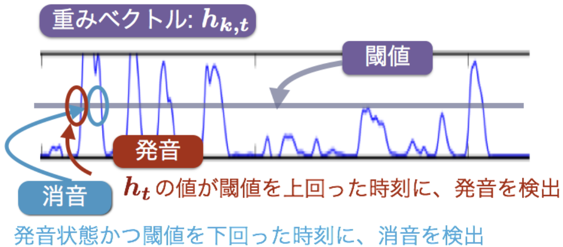
図 3.1: 単純な閾値処理における発音・消音検出の例
